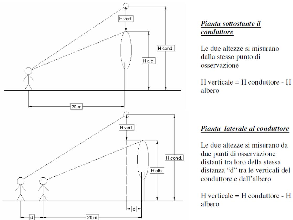
**Figura 2 - Esempio di rilevamento altezza tramite Ipsometro**
