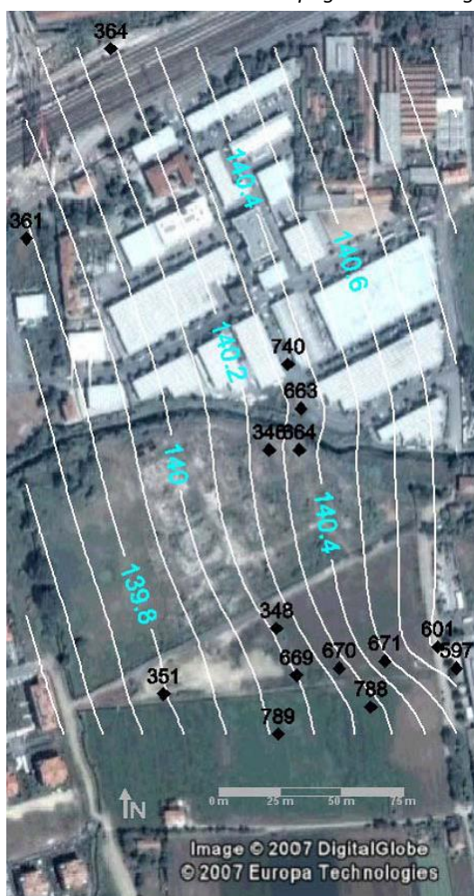
Figura A.9 - Ricostruzione della superficie piezometrica dell'acquifero A1 tramite rielaborazione geostatistica dei dati relativi alla campagna del 12 Giugno 2007
