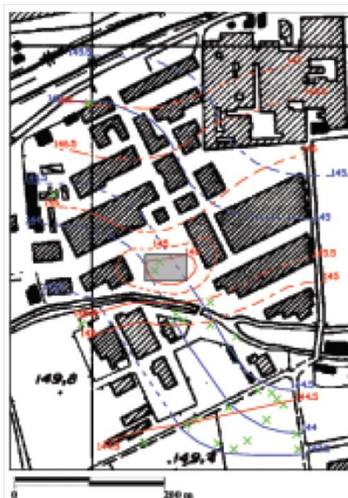
Figura A.6 - Mappa piezometrica dell'acquifero superficiale L1 e il primo acquifero L3 della zona industriale 1: linee isofreatiche dell'acquifero superficiale, 2: linee isopiezometriche del primo acquifero 3: piezometri monitorati 4: area contaminata 5: fiume Olona
