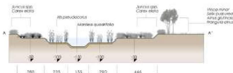
Foto, pianta e sezione di stagno con diversificazione delle profondità e indicazione delle specie da piantumare.
